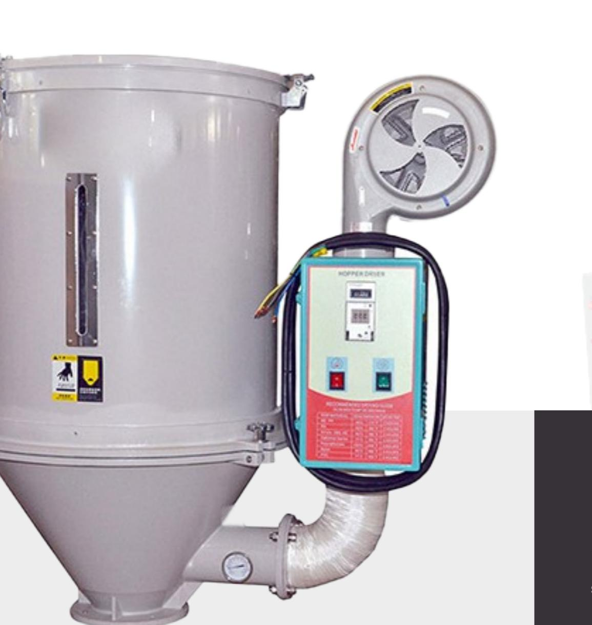
گاز گیر ها عموما در صنعت پلاستیک به جهت گاز گیری و رطوبت گیری مواد اولیه استفاده می شود . این عمل برای بهبود در کیفیت محصول خروجی و جلوگیری از حباب دار شدن پروفیل ها و شیت ها استفاده می شوند .
